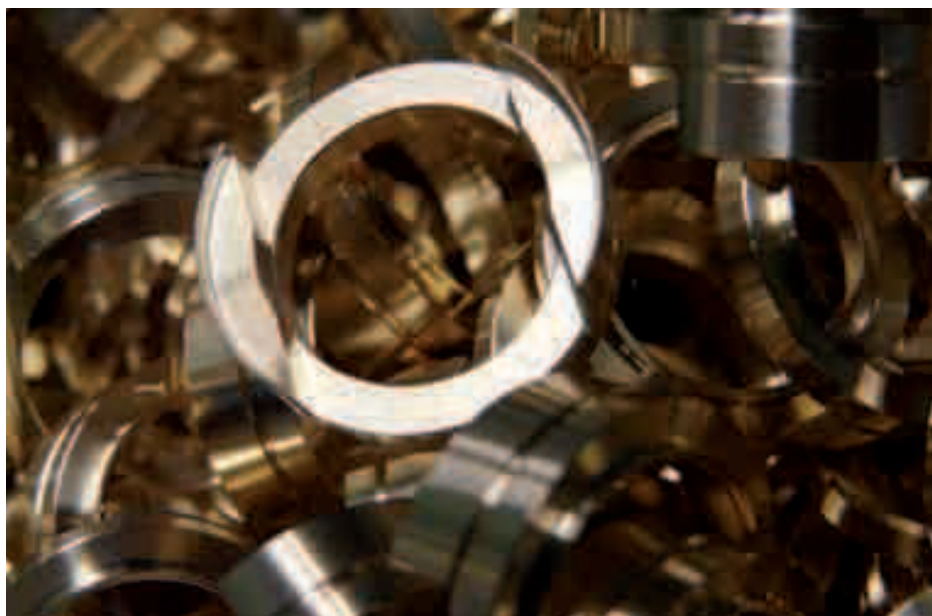
Messing producten, met zowel draai- als freeswerk, gemaakt in een machine met aangedreven gereedschappen en meerdere assen.
