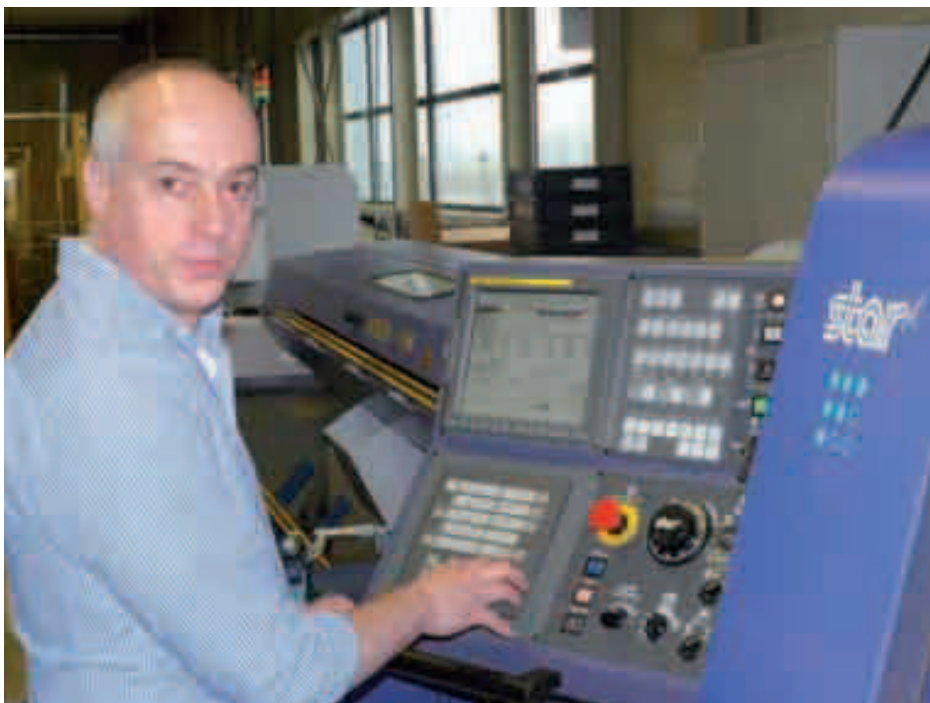
Lucien Heemskerk naast de vorig jaar aangeschafte Star langdraaiautomat met stafaanvoer, waarmee uren achter elkaar onbemand geproduceerd kan worden.
