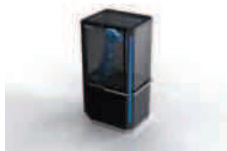
De nieuwe \mu C5 robotcel kan eenvoudig naast/voor een bewerkingsmachine worden gereden, waarmee een onbemande cel ontstaat.
